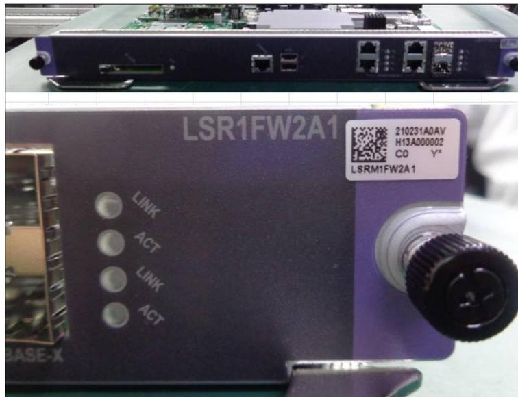
图 18 模块产品（板卡）本体序列号标签粘贴示意图
