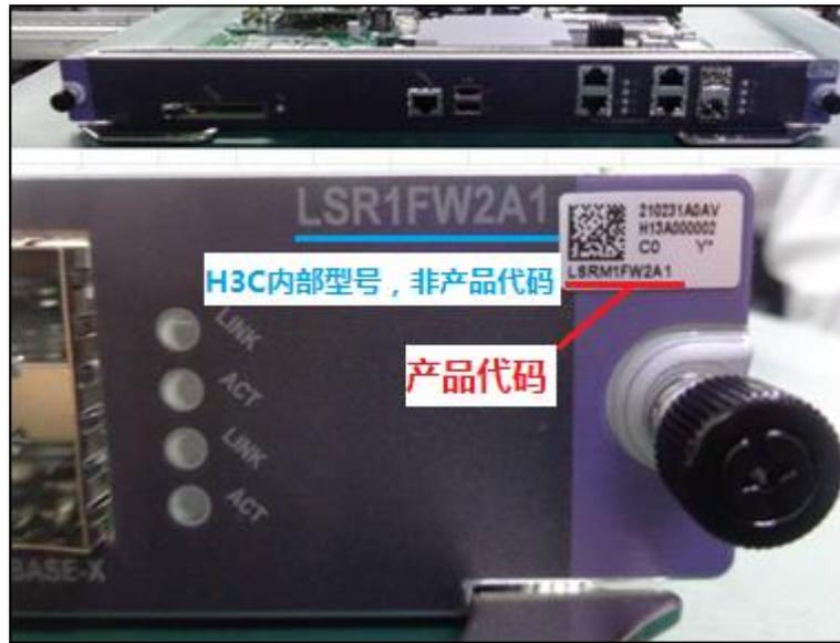
图 21 模块产品（板卡）序列号标签示意图
